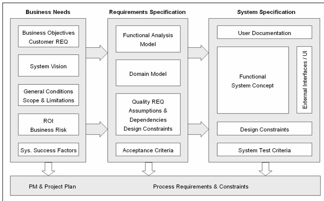
Abb. 1: Überblick über das REM Requirements Engineering Artefaktmodell
