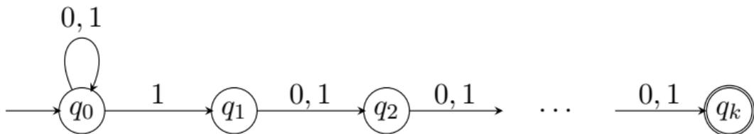
Die Potenzmengenkonstruktion liefert einen DFA für  $L_k$  mit  $2^{k+1}$  Zuständen. Geht es kompakter?
