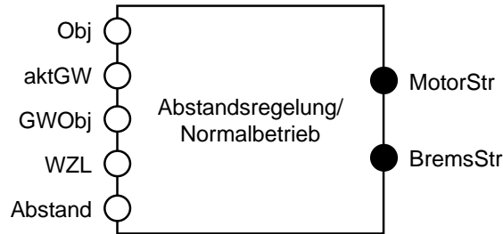
Abbildung 19: Abstandsregelung Normalbetrieb (Interface)
